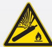
Pericolo bombola pressurizzata W029
