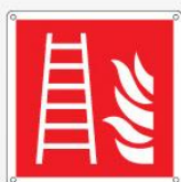
Scala antincendio F003
