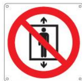
Divieto l'uso di questo ascensore alle persone P027 ●
