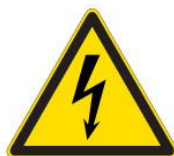
Pericolo elettricità W012
