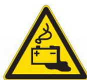
Pericolo batterie in fase di carica W026
