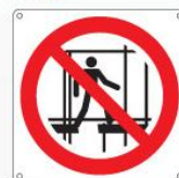
Divieto l'uso di questa impalcatura incompleta P025 ●
