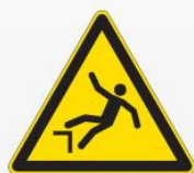
Pericolo di caduta con dislivello W008
